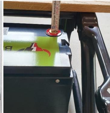
Beim stehenden Einbau unter dem Fiat Ducato Sitz, bleiben noch bis zu 4,5cm Luft für den Anschluss der Polverbindungen. Diese Batterie braucht weniger Platz als eine 95Ah Blei/AGM/GEL-Batterie.
