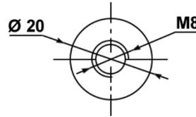
Anschluss: M8 Schraube oder M8 Poladapter
